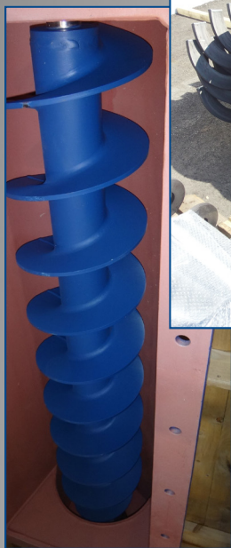
спираль на вал / shaft screw blade
