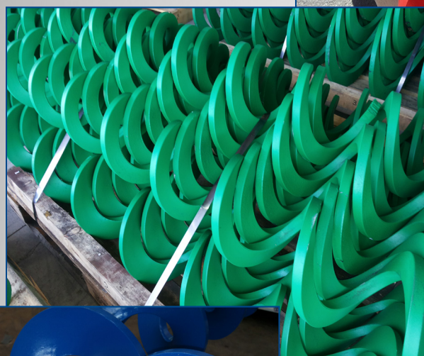
спираль без вала / shaftless screw blade
